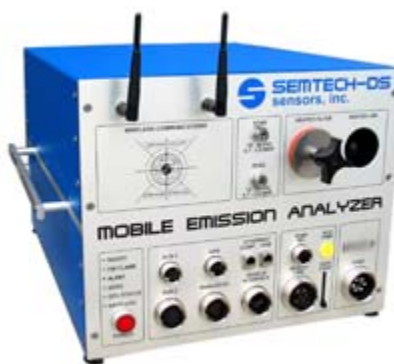
Figure 6 : Dispositif portatif de mesure des émissions Semtech DS ( http://www.sensors-inc.com/ds.html )
